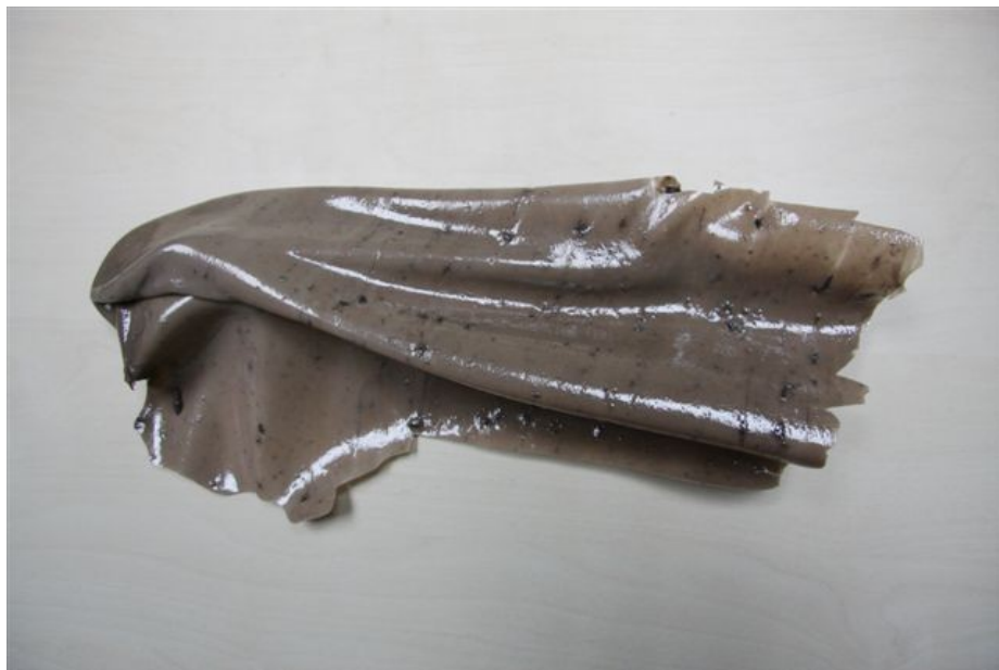
Schneckenreinigung nach 6 Wochen Fahrzeit mit unterschiedlichen Farben
